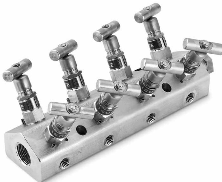
Двухкомпонентное шарнирное соединение позволяет использовать невращающуюся иглу; соединение расположено выше уплотнения и защищено от среды системы.
