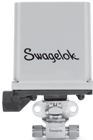
Электрические приводы Swagelok могут использоваться для управления положением шаровых кранов для КИП Swagelok; предлагаются модели постоянного и переменного тока. Для изменения положения крана используется электрический сигнал, подаваемый из удаленного пункта. Встроенные переключатели передают выходной сигнал о текущем положении крана, даже если он находится в промежуточном положении. Приводной вал данных приводов вращается в одном направлении.
