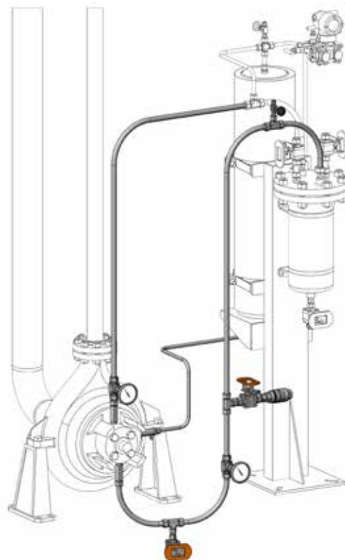
Рисунок 34. Схема API 53C — Комплект Комплект изображен в уже собранном виде и содержит несколько опциональных компонентов.
